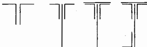
Hình 4.10. Mặt cắt thanh biên loại một thành đứng
