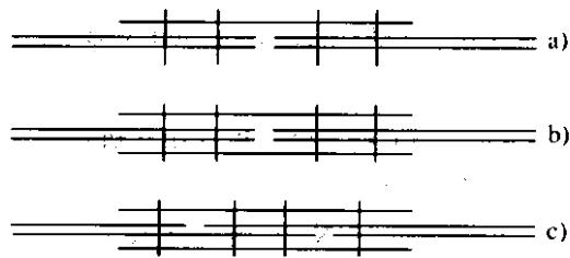
Hình 5.13. a, b - nối đối đầu, c - nối so le
